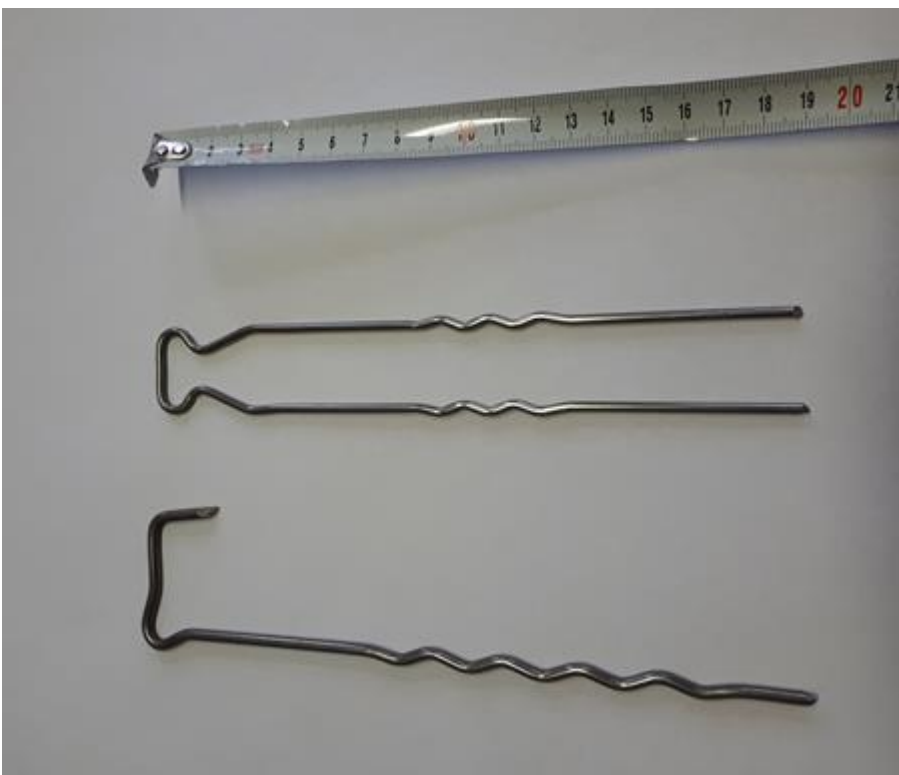
Obrázek 45: Ocelová kotvící skoba z hladkého drátu o průměru 3mm (písmeno U) a 3,8mm (písmeno J) s profilací
