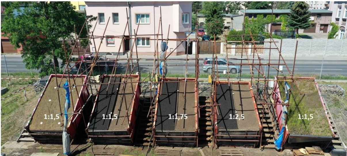
Obrázek 1: Pohled na umístění jednotlivých ploch včetně jejich sklonu. Na třech prostředních kontejnerech jsou umístěny konstrukce dešťového simulátoru.
