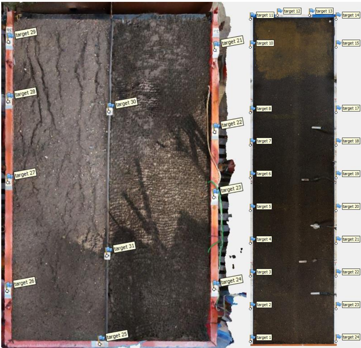
Obrázek 13: Umístění a počtu referenčních terčů na experimentální ploše (a) lokality Jirkov (na obrázku vlevo) a (b) halového DS ČVUT v Praze (na obrázku vpravo).
