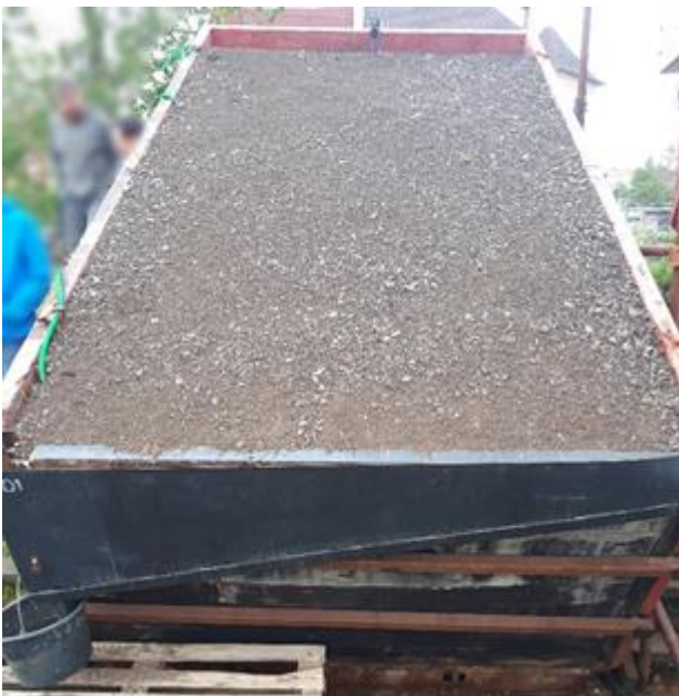
Obrázek 64: Experiment na usmyknutí humózní vrstvy bez protierozních opatření - před a po provedení testu
