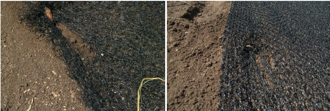
Obrázek 53: Porovnání vytržení kotvičky při orientaci po tahu a kolmo k němu
