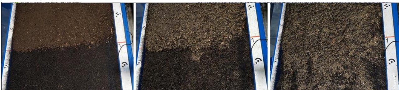
Obrázek 38: ukázka rozplavování předělu u částečně zasypané plochy. Vlevo před experimentem, uprostřed po experimentu se srážkou 60 mm/h a vpravo po srážce 160 mm/h
