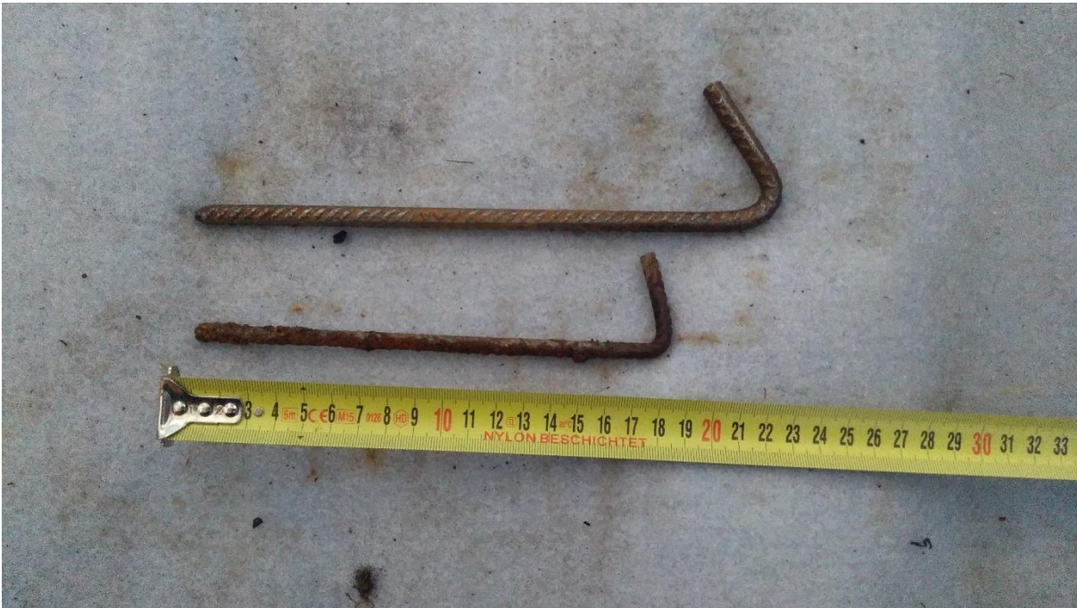
Obrázek 44: Ocelové kotvy z ohýbané žebříkové ocele různých tvarů a délek o průměru drátu 6 až 10mm
