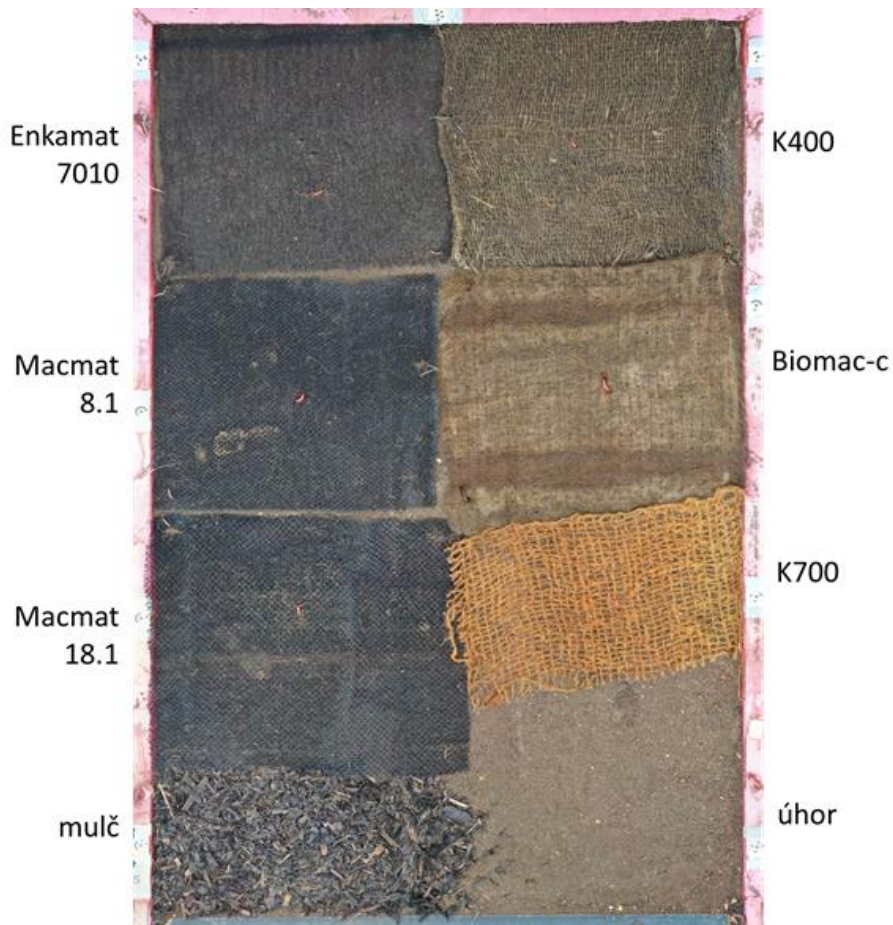
Obrázek 26: Experimentální plocha č. 5 určená pro dlouhodobý monitoring na přirozeném dešti
